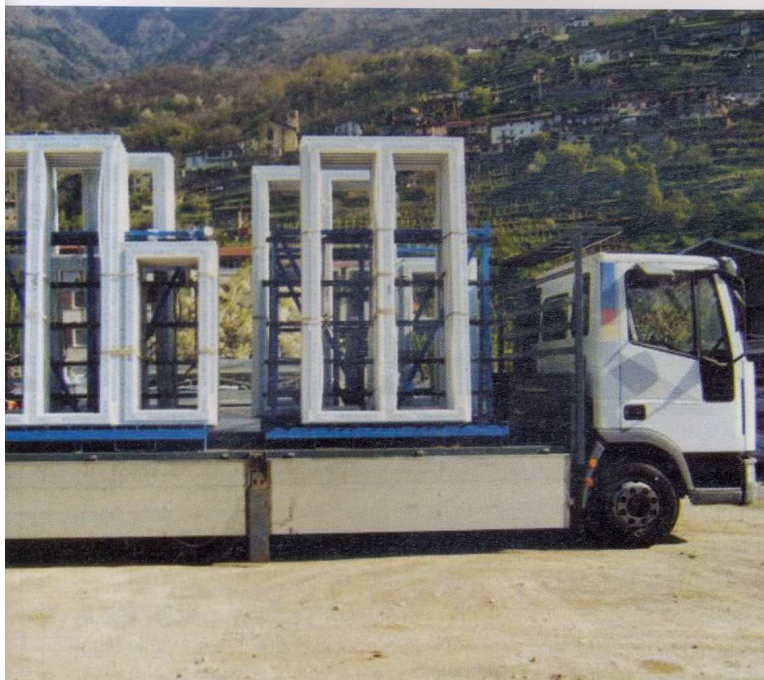
Fig. 2 - Mezzo di trasporto per serramenti e vetri.
