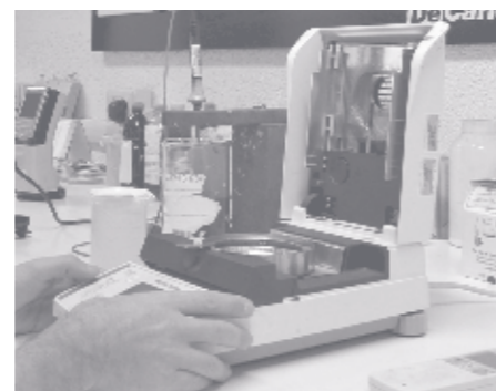
Sistema di misurazione elettronica del residuo secco delle vernici
