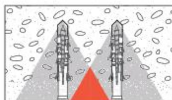
Insufficiente distanza fra l'interasse dei fori
