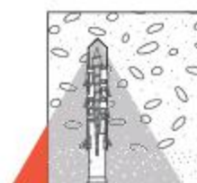
Insufficiente distanza dal bordo
